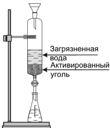
Установка для очистки воды адсорбцией
